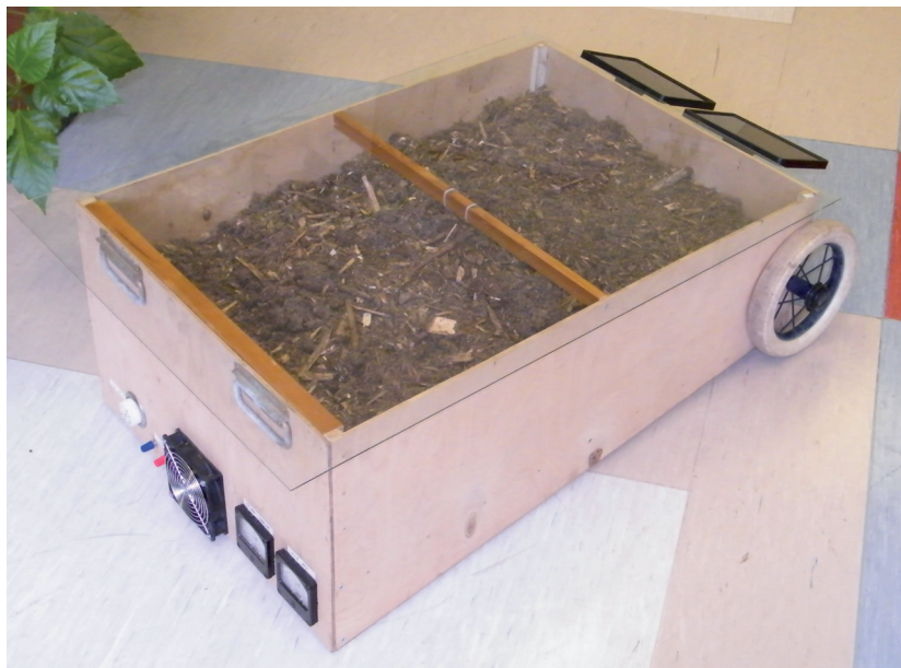
Joonis 1. Katsekuivati, mis kasutab päikesekiirgust soojuse ja elektrienergia allikana
