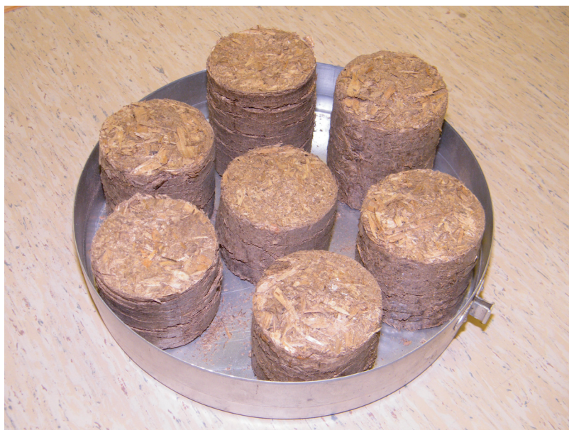
Joonis 2. Kütusepartii „Hobujõud 2“ on pressimisele eelnevalt homogeniseeritud. Briketi tihedus 950 \text{ kg/m}^3 , niiskus 10% kogumassist Figure 2. Set of fuel „Horsepower 2“ before briquetting homogenized. Density 950 \text{ kg/m}^3 , moisture content 10% WB
