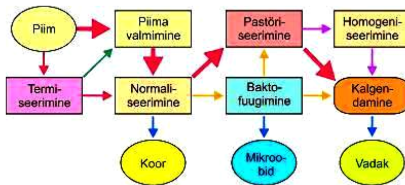
Joonis 17. Piima eeltötluse skeem (rasvase noolega on tähistatud eeltötluse kõige levinumate operatsioonide järjestus)
