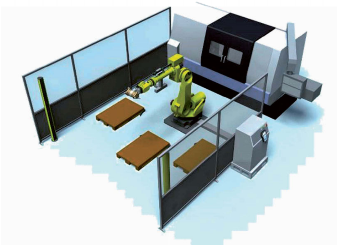
Joonis 1.14. Mehaanilise töötlemise robot-tehnoloogiline kompleks (Fastems Oy, [12])
