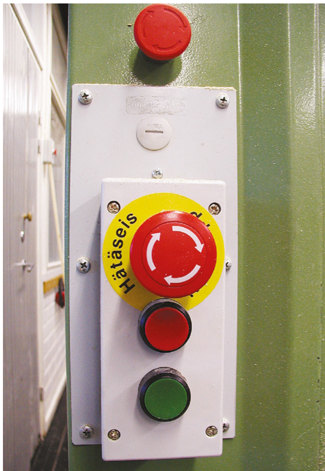
Joonis 21.5. Vajaduse korral peavad masinal olema hädaseiskamisseadmed
