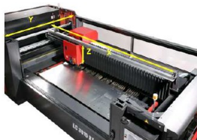
Joonis 3.82 Laserpingi lõikepea liikumise kolm telge (X, Y, Z)
