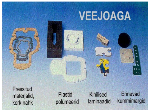
Joonis 3.132 Veejoaga lõigatud erinevast materjalist detailid
