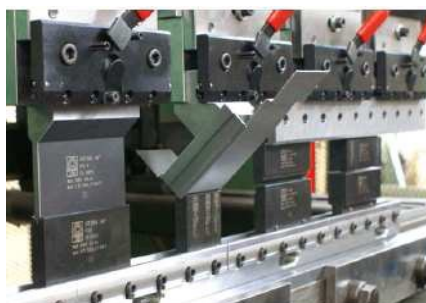
Joonis 3.108 Seksioneeritud tööriistade kasutamine
