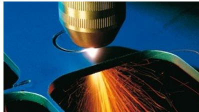
Joonis 3.437 Lehtmaterjali lõikamine plasmajoaga
