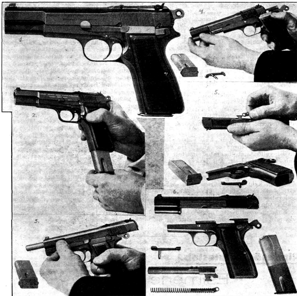
Moderniseeritud Browning 9 mm üldpilt ja järkjärgulised tegevused lahtivõtmiseks.
