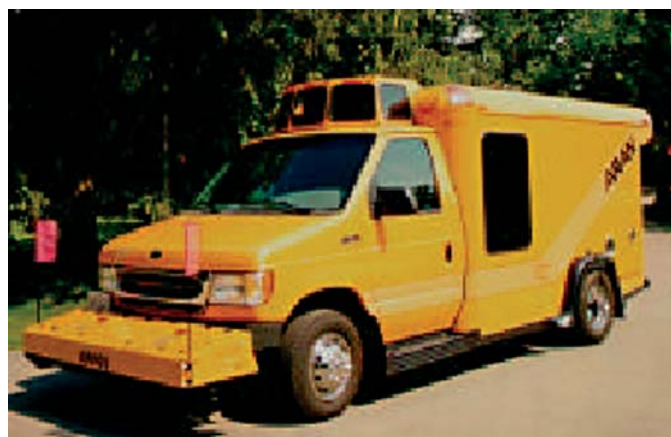
ARAN 4900, kuni 15 erinevat teede mõõdistamise alamsüsteemi, Roadware Group Inc
