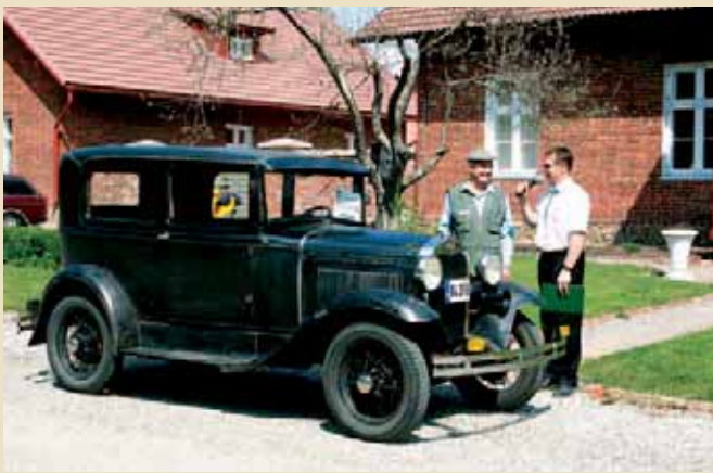
Vanaauto omanik Märt Kirik näitab 1930. aastal Kanadas valmistatud Ford A-d, võimsus 40 hj, mootori maht 3200 cm 3 , max kiirus 90 km/h.
