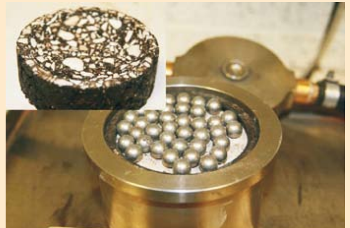
Kulumiskindluse katsel kasutatavad kuulid ja katse läbinud proovikeha.
