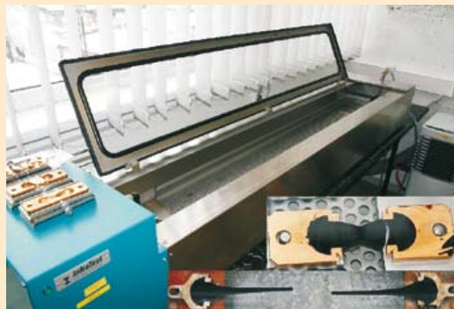
Elastne taastumise katseseade ja katse läbinud proovikehad.
