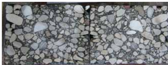
Joonis 3. AC 32 base proovikehade ristlõiked
