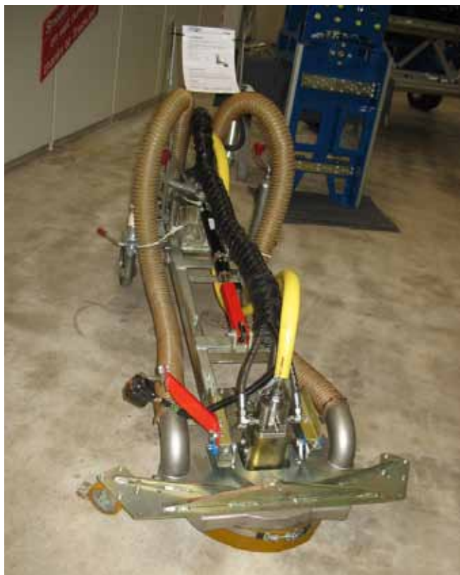
Foto 4. Selline on PeelJet -masina tööorgan
