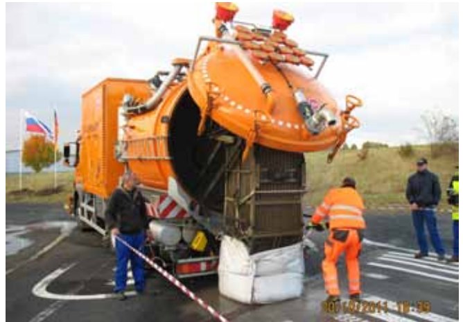
Foto 7. PeelJet-masina tühjendamine jääkidest. Samamoodi käib ka TrackJet-masina tühjendamine
