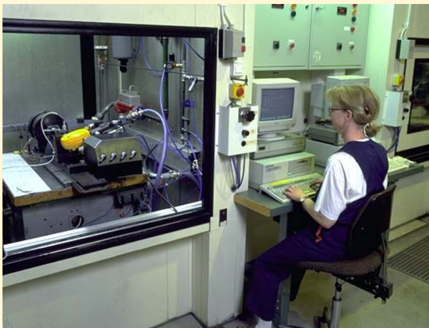
Hermetiseeritud süsteemiga (tõmbekapp) loome töökeskkonna, kus töötajal puudub kontakt kemikaaliga.
