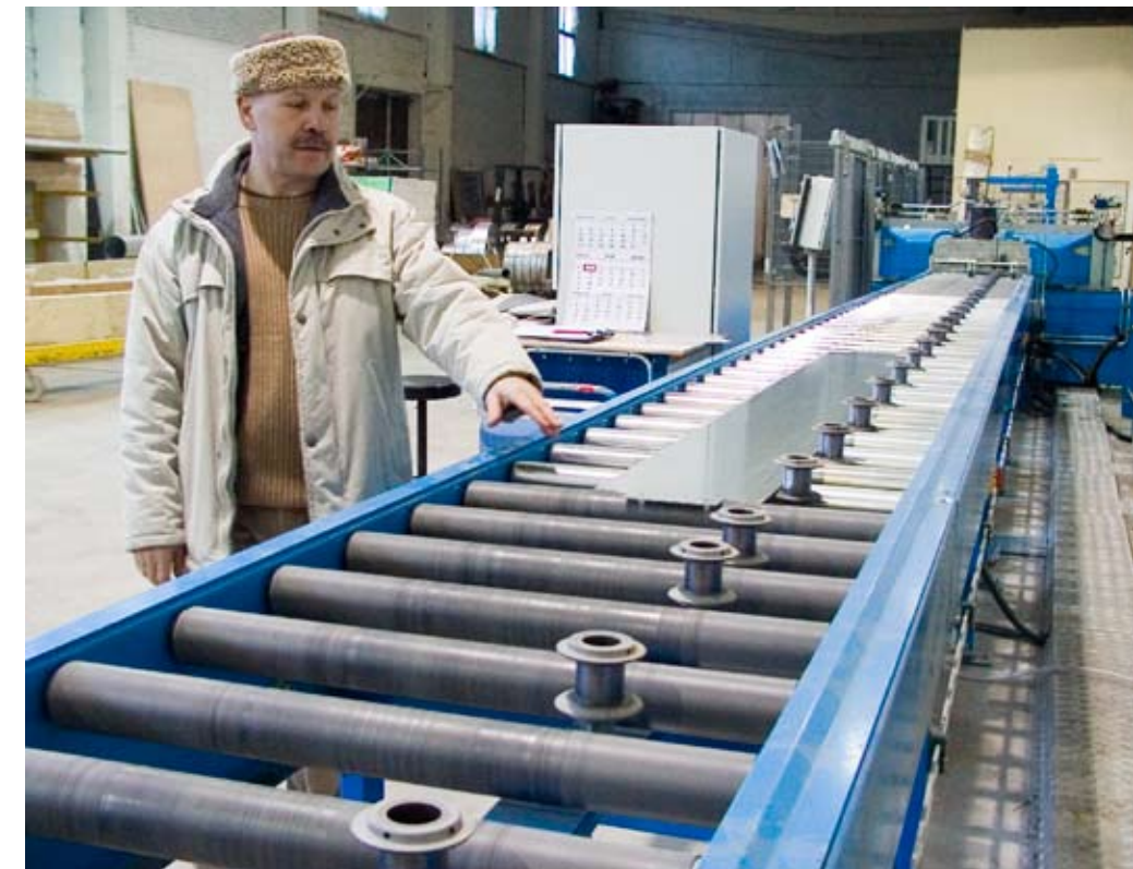
Loodesystemi omanik ja juht Raul Loomets tutvustab termoprofiili tootmisliini, mis suudab ööpäevaga valmistada viie eramukomplekti jagu karkassimaterjali.
