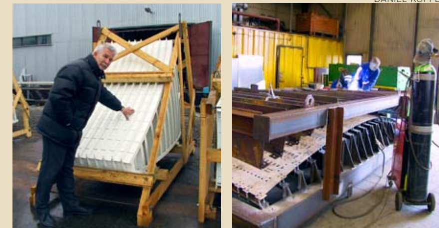
Vertex Estonia juhataja Aleks Rulkov näitab reflektori sektoreid, millest igaüks peab sobituma just sellele ettenähtud paika.
