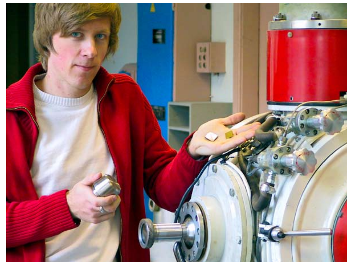
Tallinna Tehnikaülikooli teadur Andre Gregor näitab Saksamaal eritellimusega valminud ümmargust katoodi, mis pinnete tekitamise käigus peaaegu olematuks kulub. Teises käes on näha pinnatud proovidetailid.
