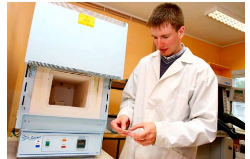
Teadur Indrek Kivi valmistab ette kütuseelemendi poolelementi termiliseks töötlemiseks muhvelahjus.
