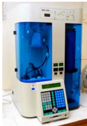
Gaasi adsorptsiooni mõõtesüsteem tahke-oksiid-kütuseelemendi katoodide ja anoodide eripinna ning pooride jaotusfunktsiooni määramiseks.
