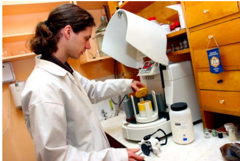
Teadur Silvar Kallip valmistab elektrolüüdi- ja katoodimaterjale sünteetiks ette planeetarse kuulveski abil.
