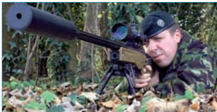
Briti kaitseväge ametnik Kieren Macmahon testib Inglise uut snaipri-püssi Accuracy International, mille kaliiber on 8,59x70 mm. Varem kasutati sama firma ehitatud püssi kaliibriga 7,62x51.
