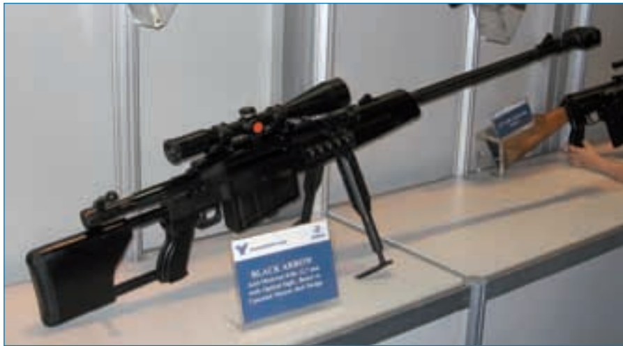
Serbia firma Zastava suurekalibrilist täpsuspüssi M 93 Black Arrow (Must Nool) valmistatakse kaliibriga 50 BMG ehk 12,7x99 ja 12,7x108. Endise Jugoslaavia alal peetud sõdades kasutati seda palju. Relvaga käib kaasas kaheksakordne optiline sihik, millele on sihtimispunktid kuni 1800 meetrini.
