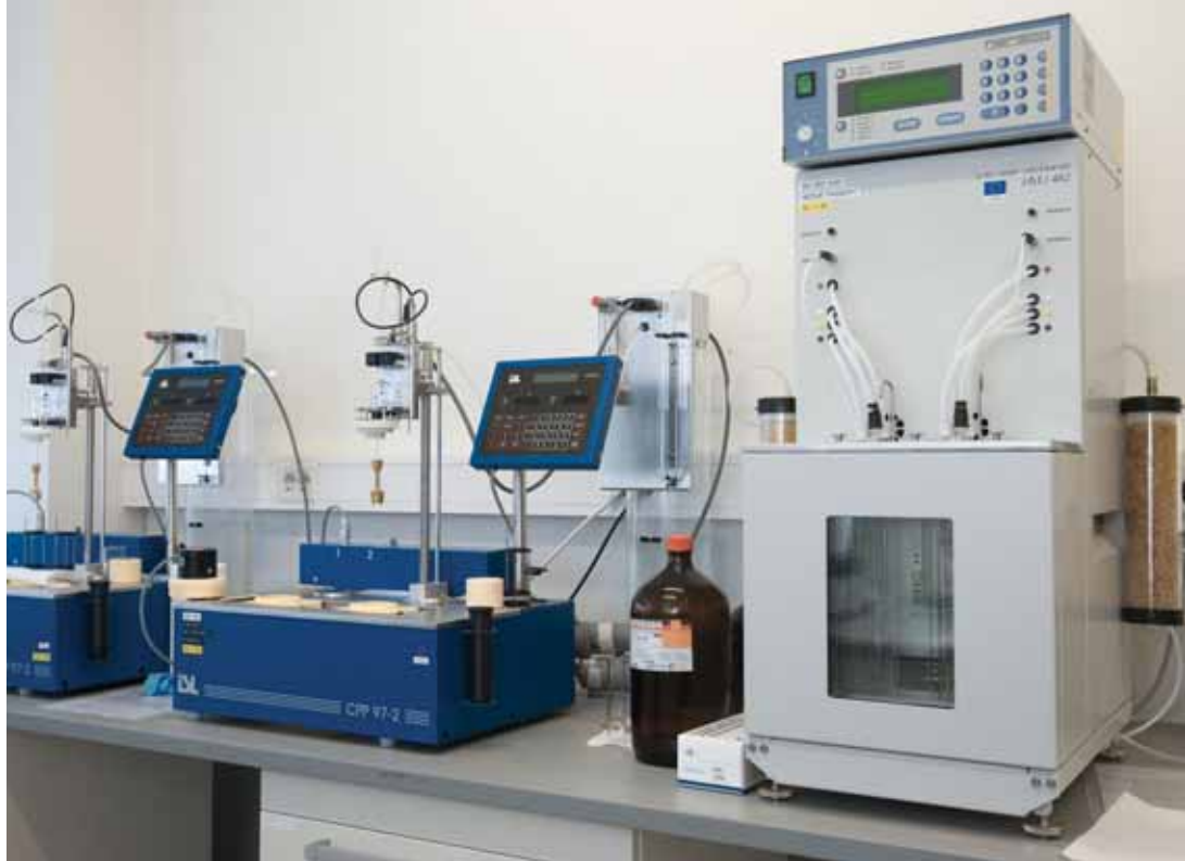
VISKOSIMEETER (PAREMPOOLNE SEADE) JA KAKS SEADET (VASAKUL) KÜTUSTE KÜLMUMISOMADUSTE (HANGUMISPUNKT, HÄGUSTUMISPUNKT, KÜLMFILTRI UMMISTUSPUNKT) MÄÄRAMISEKS
