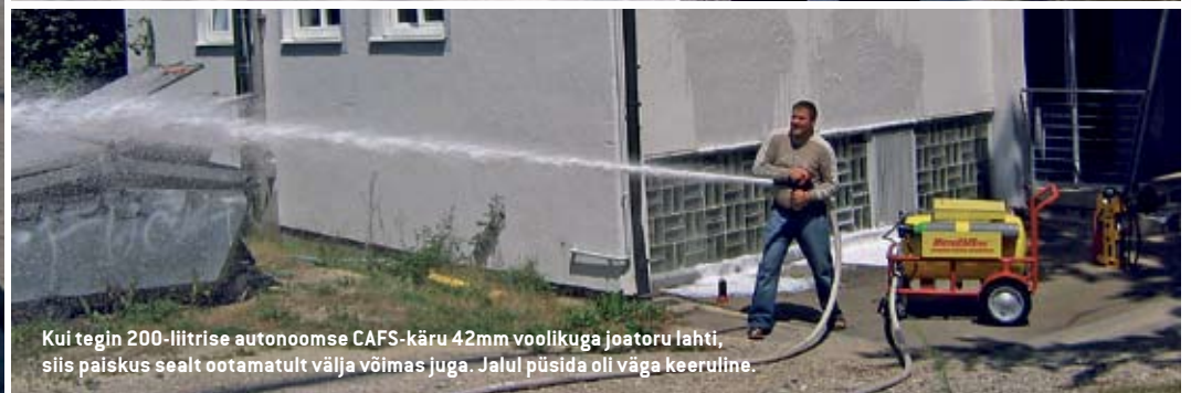
CAFS-joatoru läbi seina või katuse löömiseks – enne tulekahju ruumi jõudmist kasutatakse seda põlengu turvavahuga katmiseks, põlemise ajal kustutamiseks.
