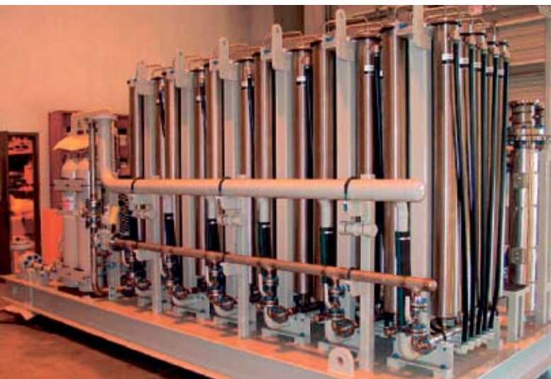
••Pilt 3•• Lämmastikgaasi N 2 generaator, mis toodab tuldokumentatavat gaasi välisõhust.
