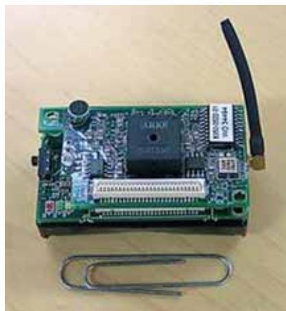
Joonis 1. Arupuru kübe aastast 2004, varustatud kiirendus-, magnetvälja ja temperatuurianduriga ning mikrofoniga
