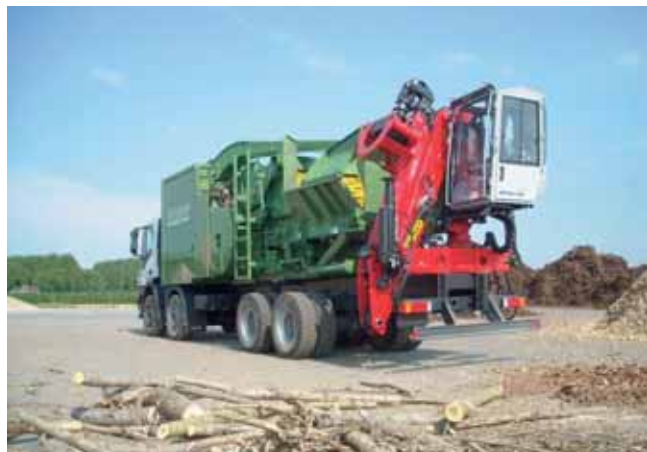
Veoautole paigaldatud Pezzolato PTH-seeria trummelhakkur
