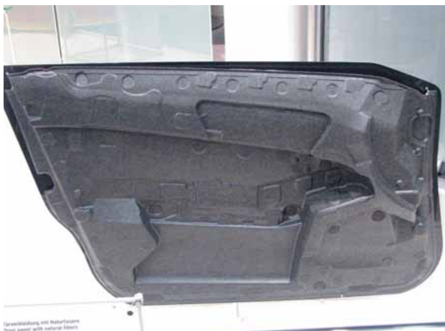
Joonis 3. Looduslike kiududega sarrustatud termoplastist survevalu-autoukse sisepaneel
