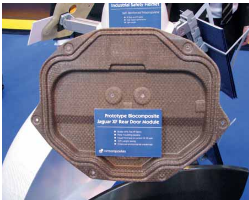
Joonis 2. Biokomposiidist autoosa
