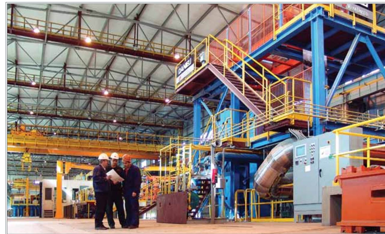
Новолипецкий металлургический комбинат. Агрегат горячего цинкования
