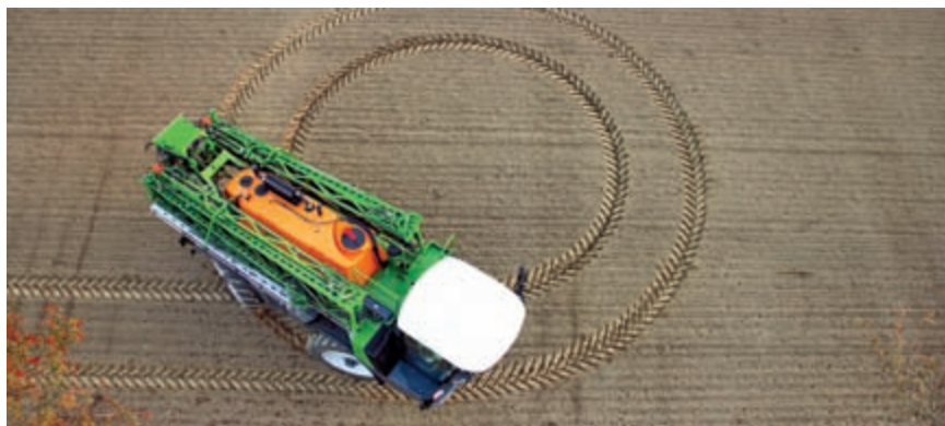
Neljarattaroolimine võimaldab Panteral teha 4,5meetrise raadiusega pöördeid.
