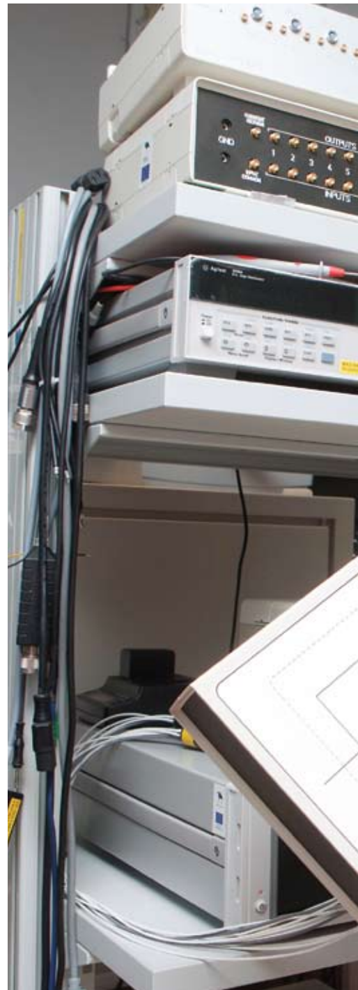
VÕLTS VÕI ÕIGE: Selline näeb välja võltsitud euromünte impedantsi abil avastada võimaldava seadme prototüüp.
