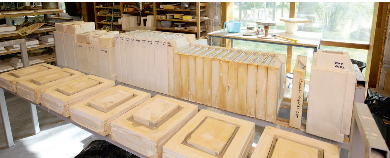
Pöletatud ja jahvatatud savist, mis jõuab Saksamaalt kohale 50kilostes kottides, segab meister kahhelkivide segu valmis ning valab siis vormidesse.
