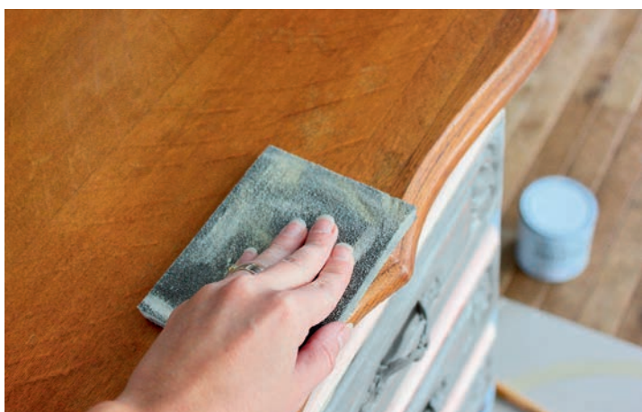
Lihvsvamm ühtlustab lakitud pinda enne vahatamist.
