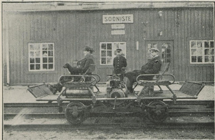
Nr. 27. Tööstuse laiarööpaline mootordresin, mis võimaldab liini rikete kiiret kõrvaldamist.
