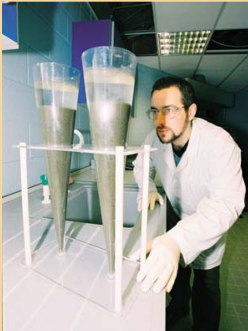
Vee dekanteerimise jälgimine ISPA finantseeritud puhastusjaamas
