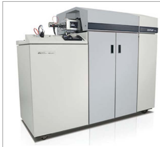
Joonis 4. Elektropihustamise ionisatsiooni (ESI) mass-spektromeeter QSTAR Elite.
