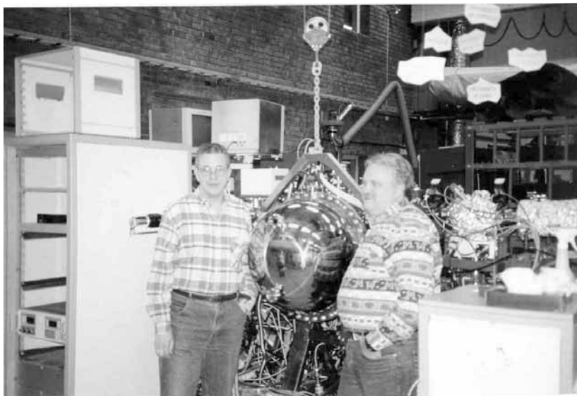
Uus võimas lõppjaam, mille põhikomponendiks on pööratav elektron-spektromeeter Scienta SES-200, on installeeritud kiirekanalile 51. Pildil Andrus Ausmees ja Ergo Nõmmiste.
