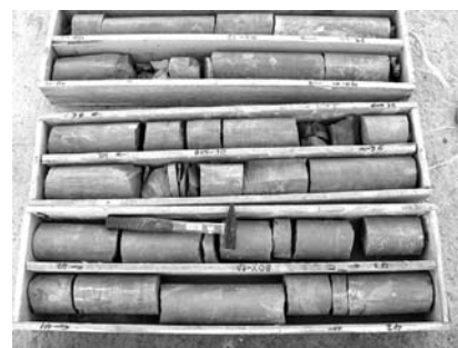
Joonis 4. Värske, porsumata pruunikas-tumehall põlevkivi on väliselt massiivne. Selle peenkihiline siseehitus ja orgaanilise aine sisalduse muutus kajastub vähe puursüdamiku välispinna ilmes.
