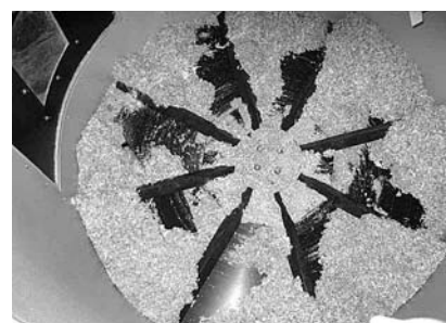
Joonis 9. Briketipressi toormepunker.
