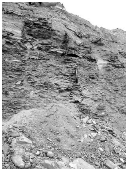
Joonis 2. Mõõdukalt porsunud põlevkivi. Kihindi ülaosa paljand El-Lajjuni maardlal. Porsumine toob välja lasundi peenkihilise siseehituse.
