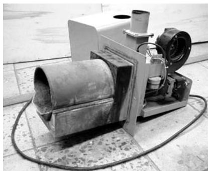
Joonis 5. Pelletipõletit IWABO Fastighet 30.
