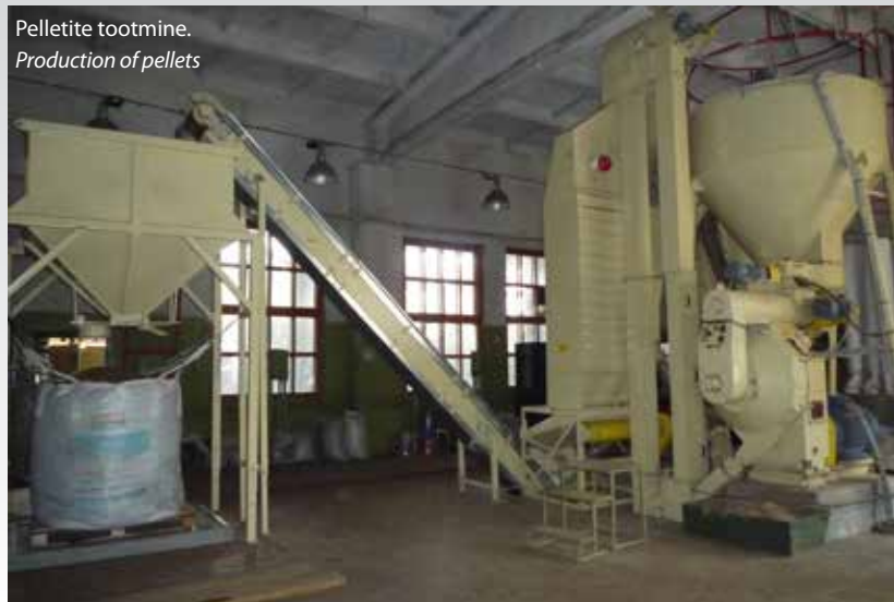
Pelletivalmistamise seade OGM-1,5A. Pellet press OGM-1,5A.
