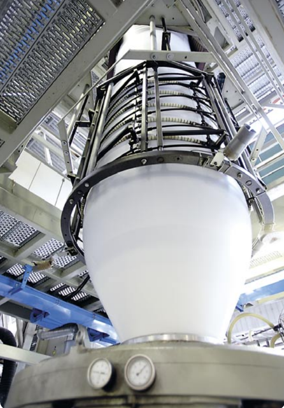
Kiletootmismasin, kus pisikestest graanulitest mitmesajakraadise kuumuse juures õhuke kile valmib.
