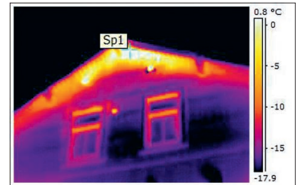
Termokaamera pilt kinnitab, et selle maja pööningu lagi ja katus vajavad põhjalikku soojustamist.
