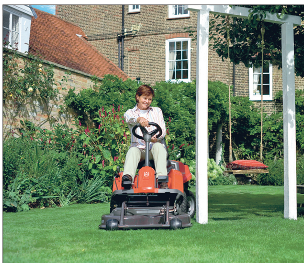
Kolme süsteemiga mootorniiduki mudel: peenestab niite, võib selle koguda või küljele välja heita.
