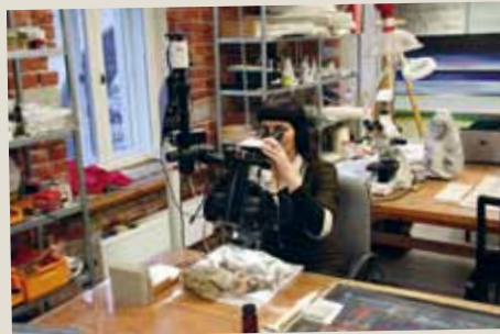
Pildil uuritakse mikroskoobi 500-kordse suurenduse abil tekstiili pinda, et seda kahjustamata kujul konserveerida.
