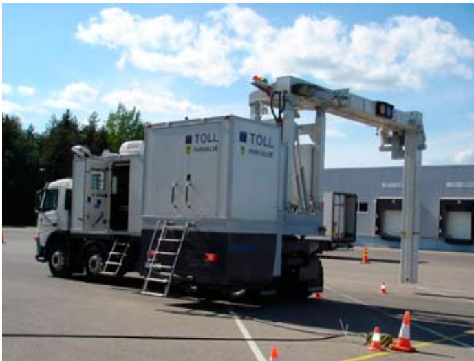
Eesti tollipunktides on tehnika ja oskused selleks, et kaubandust tõhusalt kontrollida. Pildil liikuv röntgeniaparaat. Foto: maksu- ja tolliamet
