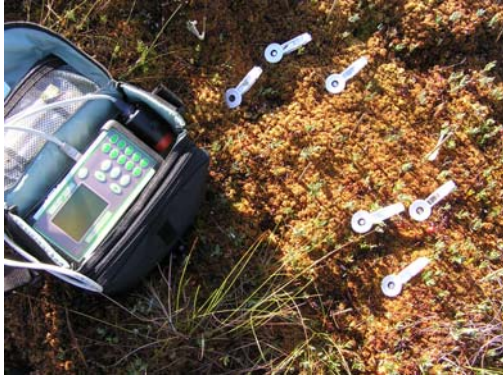
Foto 1. Klorofüllü fluorestsentsi mõõtmiseks kasutatud analüsaator Handy PEA ning proovide pimeadapteerimiseks kasutatud klambrid. (K. Sepa foto)
