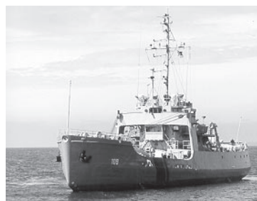
PVL-109 VALVAS: pikkus 56 m, laius 11,5 m, süvis 3,7 m, kiirus 12 sõlme.
