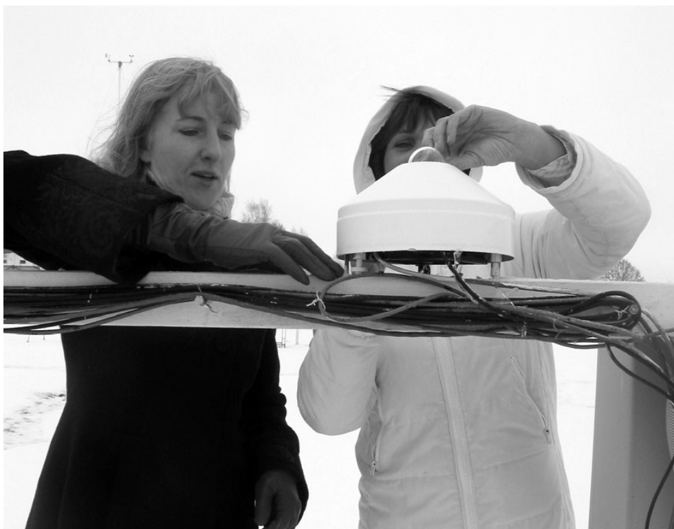
Helen Kaskema (vasakul) ja meteoroloog Karin Veskimäe kontrollivad, kas päikese-vaatluse kestvuse regulaator on töökorras. Fotod: Mare Nõmmik
