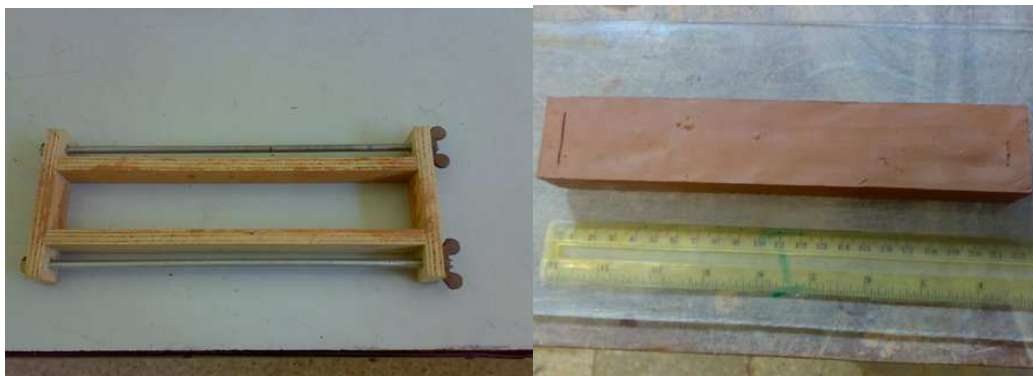
Joonis 1. Katseproovide vorm ja katseproov (fotod D.Mesteljaineni)
