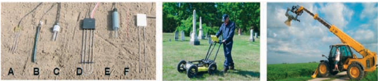
Joonis 1. Mõned mulla andurid: (A) TDR, (B) ECH20 EC-20 andur, (C) Hydra probe, (D) Acclima TDT andur, (E) ThetaProbe, (F) CS-616. Keskmisel pildil on kärule monteeritud maaradar (GPR); parempoolsel pildil on kraanale monteeritud passiivne radiomeeter (Robinson et al., 2008)
