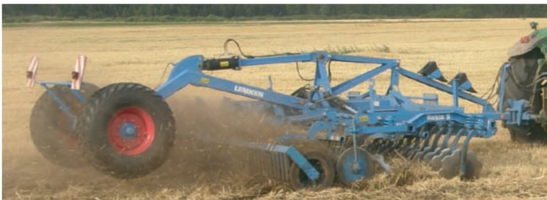
Joonis 5. Rullrandaal kerge ja keskmise löimisega muldadele
