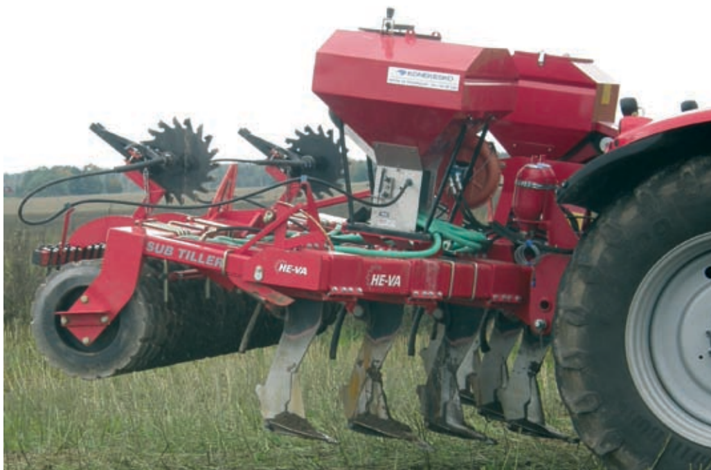
Joonis 2. Sügavkobestuse ja külvi põimmasin rapsi viljelemiseks tihenenud muldadel
