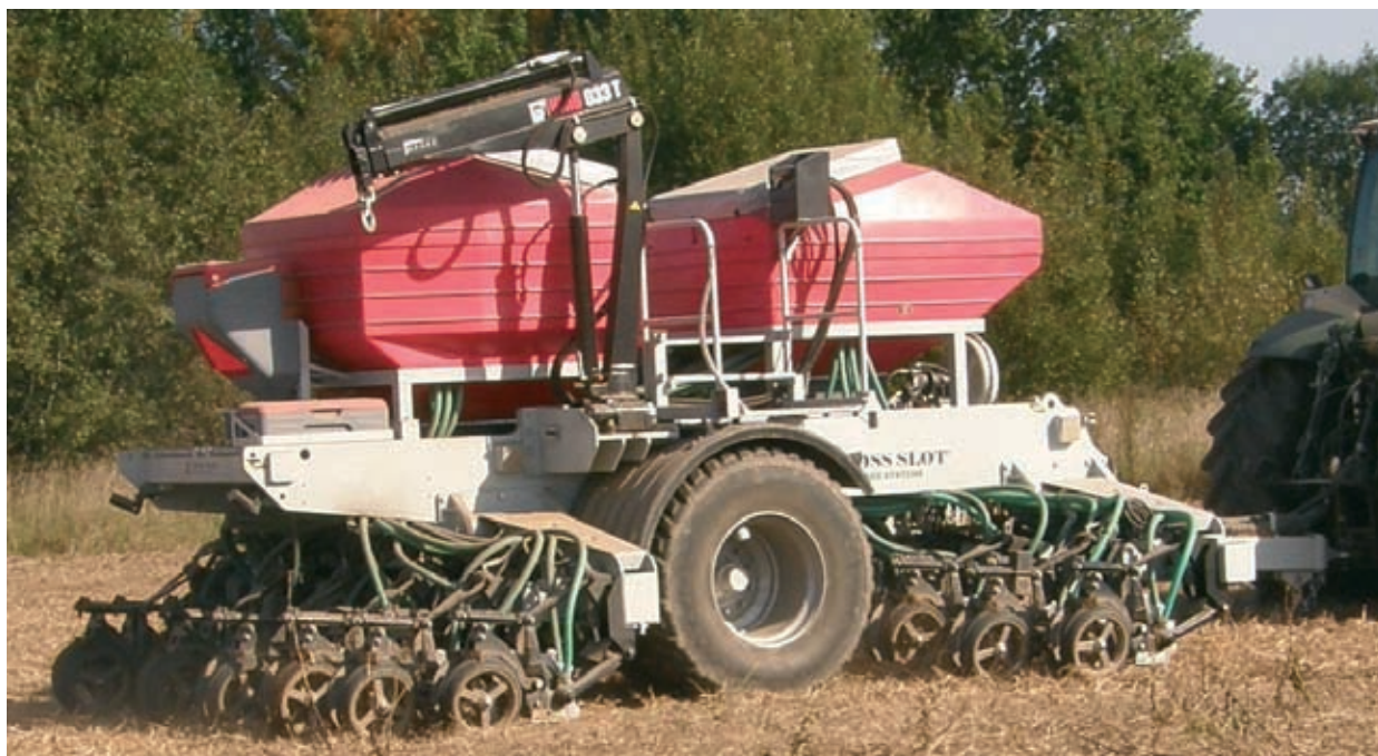
Joonis 18. Seni ainuke CROSS-SLOT otsekülvik Eestis sobib ka rapsi külviks
