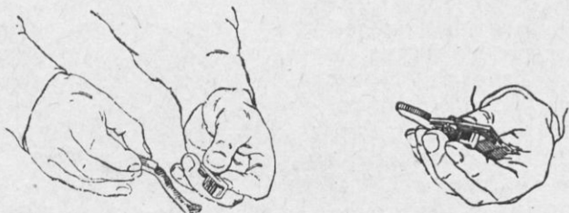
Рис. 49. Как соединить разобщик с основанием
