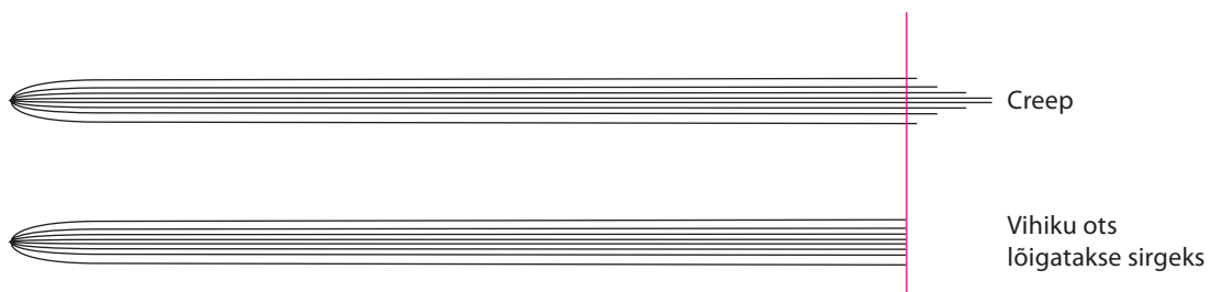
Joonis 19: Creep. Välimised lehed on lühemad kui seesmised
