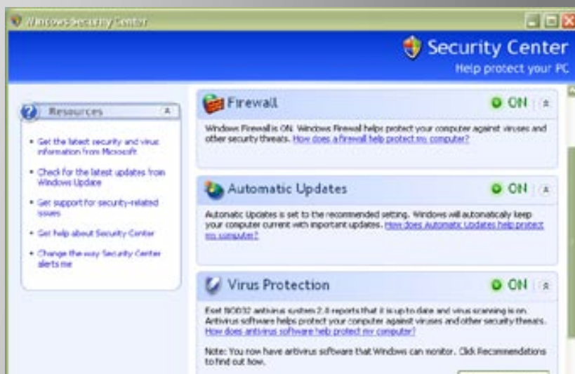
Windowsi turvakeskuses peaksid kõigi kolme sektsiooni juures põlema rohelised tulukesed. Kui seal on kollased või punased tulukesed, on põhjust kõik seadistused üle kontrollida.
