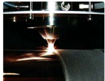
► JOONIS 4: NAFTAPUURIMISSEADME PINNAKATMINE 4 KW DIOODLASERI ABIL
