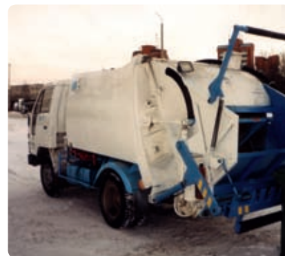
▶ EESTI PRÜGIAUTODEST NELJAS JA VIIMANE. SELLELE ALGSELT KÄSITSI LAADITAVALE EHITATI PEALE LAADIMISSÜSTEEM.
