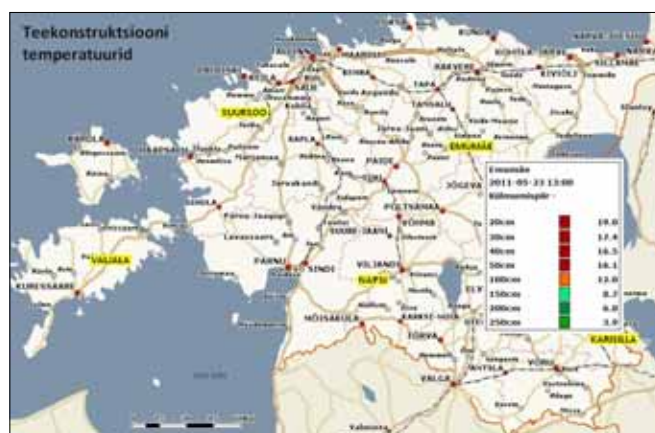
Joonis 3. Teekonstruktsiooni temperatuurid on paigaldatud uuringute tarbeks igasse regiooni ning lisaks üks Saaremaale (mereline kliima).
