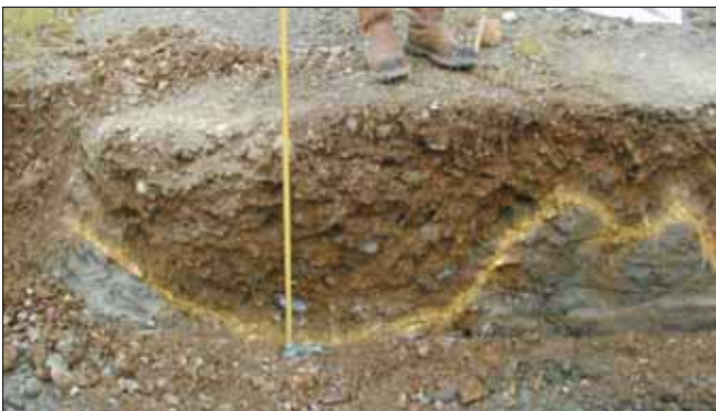
Joonis 6. Jäävdeformatsioone võib kruusateedel näha roobastena, mis on pealt järjest siledaks täidetud.
