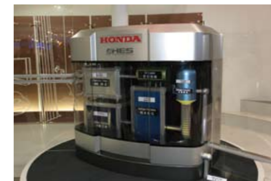
HOME ENERGY STATION: Vesinikutankla, katlamaja ja elektri jaam ühes tükis tarbib kütusena maagaasi.
