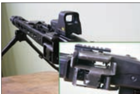
Picatinny liist MG-3-le punatäppsihiku HWS 552.A65 kinnitamiseks.
