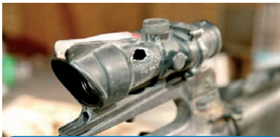
Joonis 4. ACOG-sihik pärast kuulitabamust. Kuul jäi sihikusse, andes tunnistust selle väga tugevast konstruktsioonist (kapral Miguel A. Marrasco jun).
