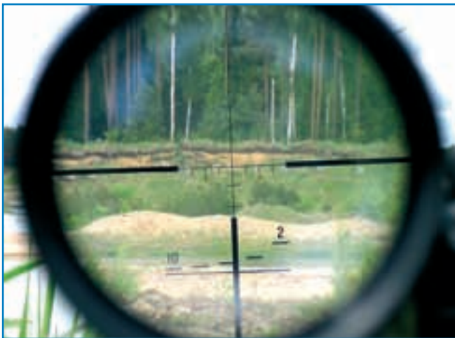
Sihikupilt Galil Snajprist 500 m kaugusele. Sihiku suurendus on kuuekordne. Kui teada nähtava objekti mõõtmeid, on sihikult kriipsukesi lugedes võimalik sihtmärgi kaugus välja arvestada.
