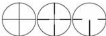
Joonis 8. Algne niitristik, duplex- (osa- liselt paksendatud joontega) ning posti tüüpi (siin Saksa) niitristik.
