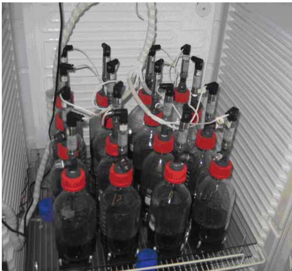
JOONIS 3: POOLTÖÖSTUSLIK ANAEROOBSE KÄITLEMISE SEADE
