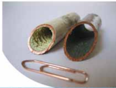
Vasktorud enne ja pärast Bauer PJ kasutusele võtmist
