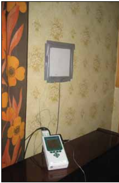
JOONIS 6. SOOJUSVOO MÕÕTMINE KORTERI VÄLISSEINA U-VÄÄRTUSE ARVUTAMISEKS
