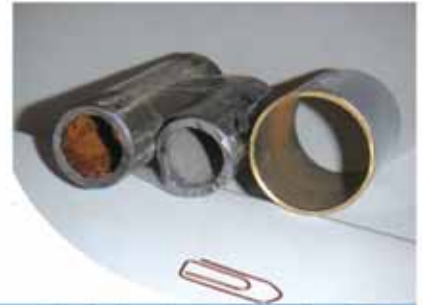
Tsingitud torud enne ja kuus kuud pärast Bauer AK paigaldamist Kadrioru korteriühistusse; parempoolne on tükk puhtaks saanud käterätikuviatist
