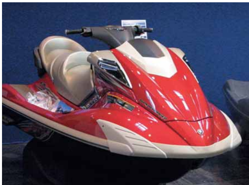
Joonis 5. RIM-tehnoloogiaga valmistatud kõvast polüuretaanist kerega skuter
