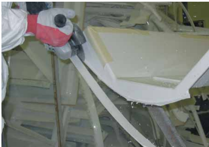
Joonis 2. AS-is Balteco tekivad komposiitplastijätmed tehnoloogilise lisa mahalõikamisel klaaskiuga sarrustatud koorikult
