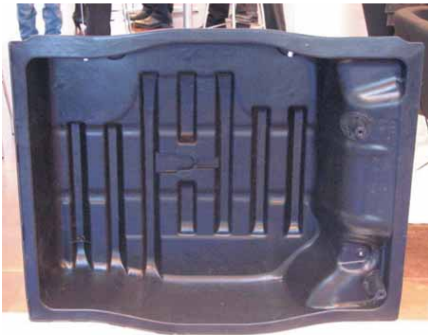
Joonis 4. SMC-meetodil (valupressimine) valmistatud klaasplastist (40%) varurattaalus
