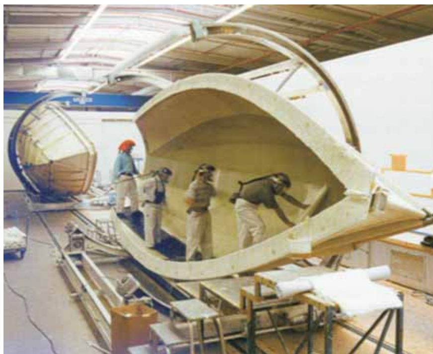
Joonis 1. Väikelaeva kere valmistamine käsitsilamineerimise teel [5]
